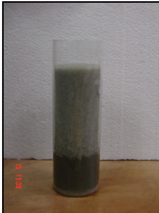
Figura 3.2 - Solo em estado não homogêneo de saturação residual, apresentando faixa de solo saturado no fundo da coluna.
