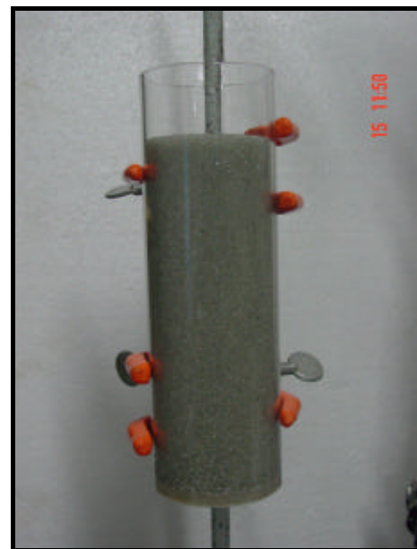
Figura 3.4 - Solo em estado homogêneo de saturação residual após sucção.
