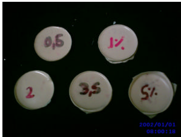
Fig.: Amostras do teste de dosagens de catalisador
