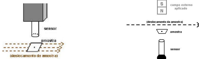
Fig. 1 – O SQUID e o sistema de Efeito Hall, usados para medir a densidade de fluxo magnético resultante das amostras. No primeiro caso, a excursão da amostra foi feita em várias linhas, a fim de garantir a passagem mais próxima ao centro do sensor. No segundo, o percurso foi feito unidimensionalmente, graças à facilidade do funcionamento e da visualização.
