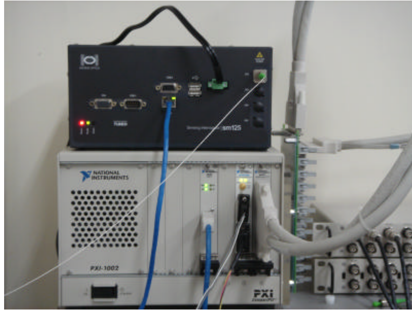
Figura 4. Em cima um interrogador de redes de Bragg da Mícron Optics e em baixo uma ponte de Wheatstone da National Instruments.
