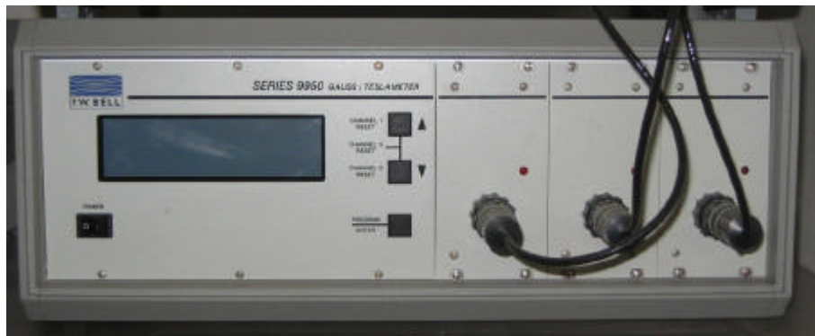
Figura 5. Magnetômetro vetorial de efeito Hall F. W. Bell 9950.
