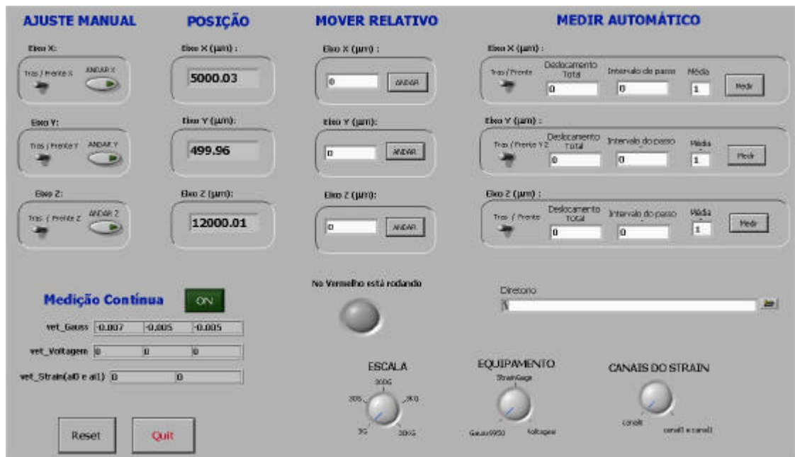
Figura7. Painel XYZ para medição de strain e campo magnético.
