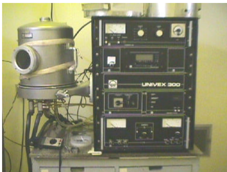
Figura 4 – Univex 300, onde realizamos as deposições de matérias orgânico para a produção de OLEDs.
