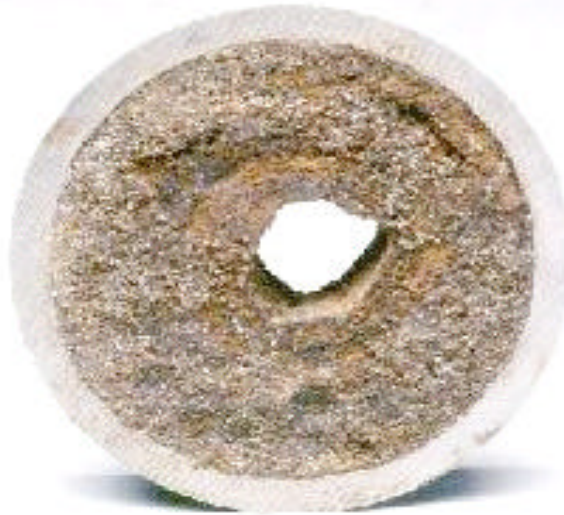
Figura 1: Linha parcialmente bloqueada por deposição de parafina.
