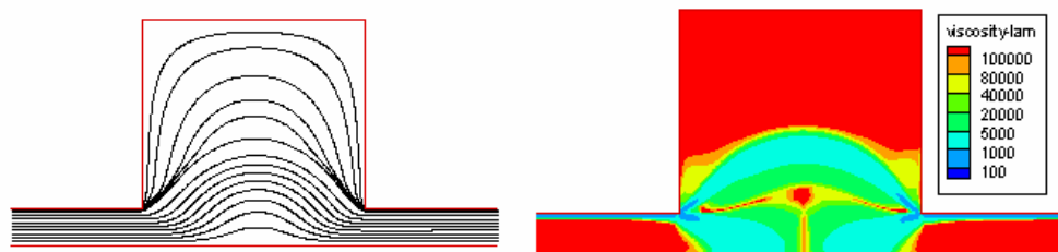
Figura 4: Linhas de corrente e viscosidade para J=1,5 \times 10^6 e n=0,41 respectivamente.
