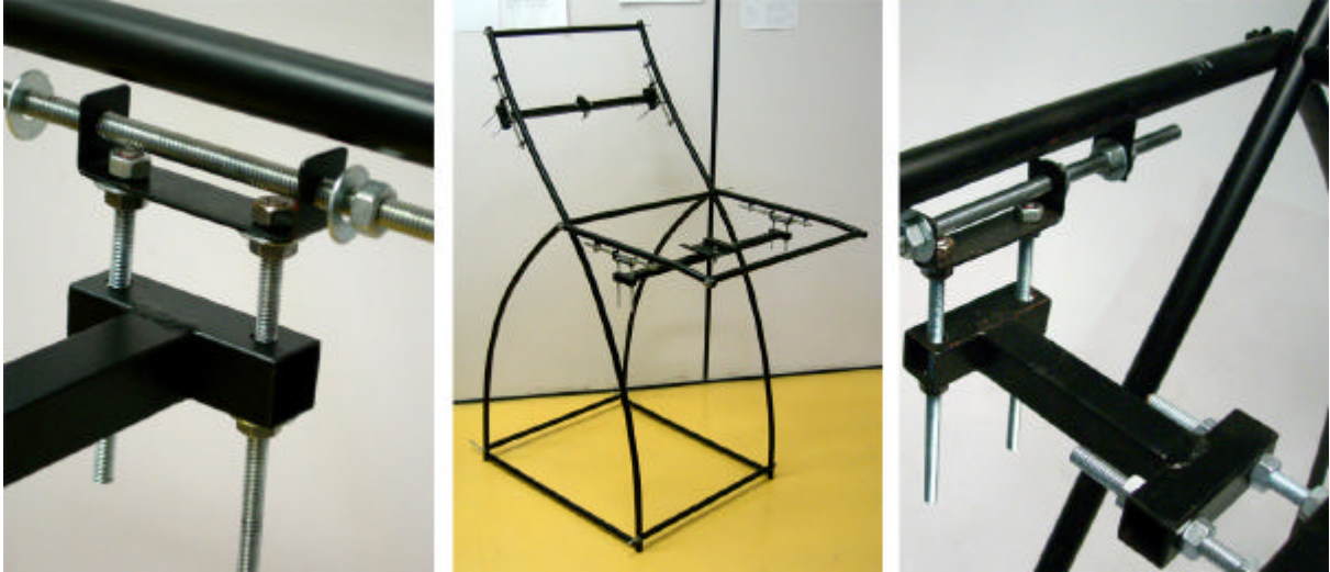
Figura 1: Estrutura desmontável em aço de carbono.
