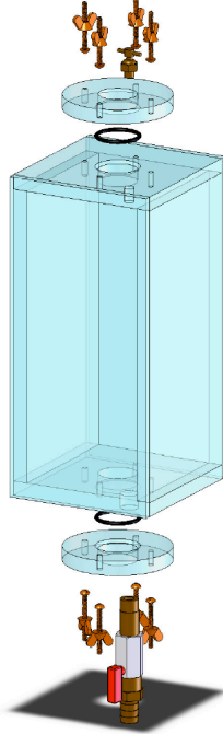
Figura 10. Vista explodida da caixa de visualização
