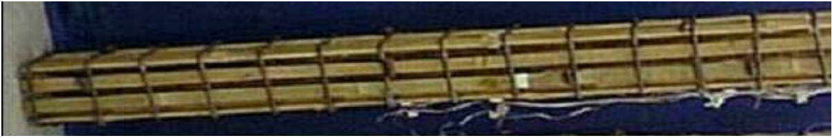
Foto 22: Armadura de bambu
