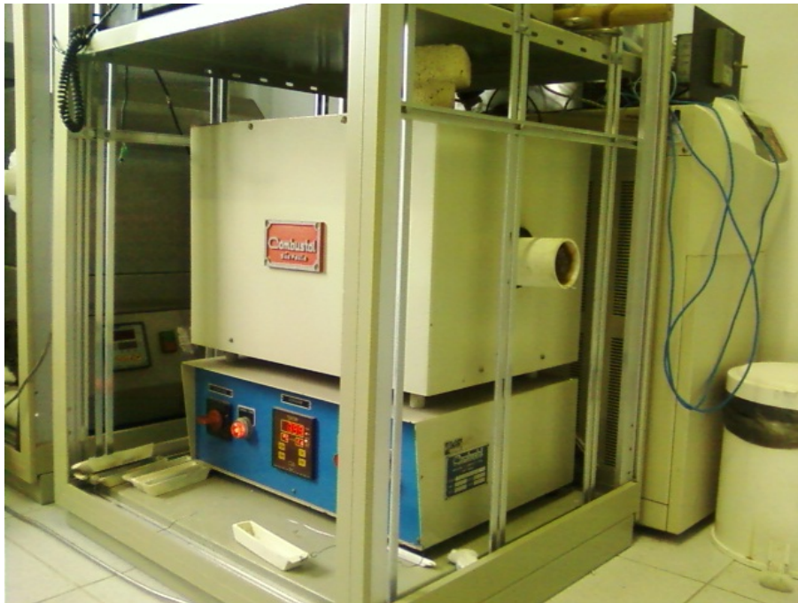
Figura 1: vista lateral do forno Combustol com o cilindro cerâmico à direita
