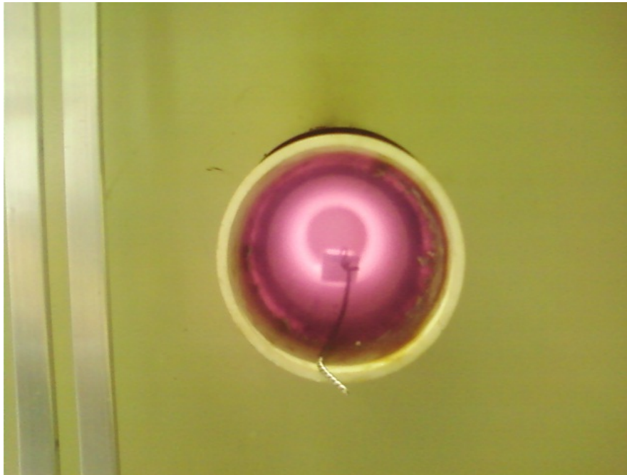
Figura 2: vista do interior do cilindro com a amostra dentro do cacinho sendo aquecidos
