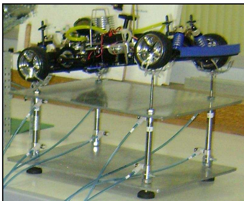
Figura 7.3: Simulador Vertical construído.
