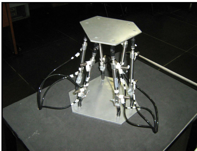
Figura 3.21: Plataforma Stewart construída.
