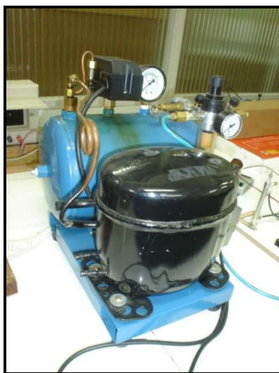
Figura 3.8: Compressor inicialmente usado para alimentar a bancada de testes do sistema válvula-atuador.
