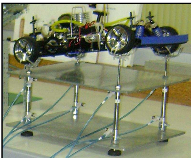
Figura 3.22: Simulador Vertical construído.
