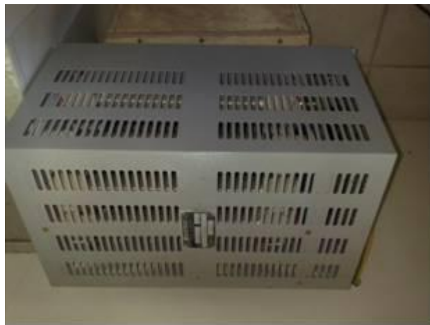
Figura 10. Detalhe do Dissipador de Potencia.
