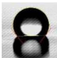
Figura 2. Imagem obtida pelo software utilizado para a medida do ângulo de contato.
