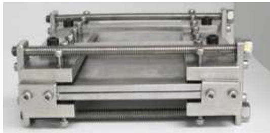
Figura 4. Seção de testes com placas inox sem revestimento.
