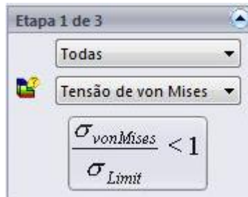
Figura 7 - Critério de falha por escoamento de Von Mises, no CosmosWorks
