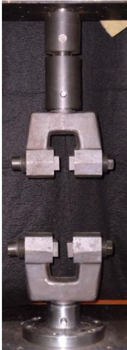
Figura 9 - Detalhe da garra utilizada no ensaio de tração do corpo de prova
