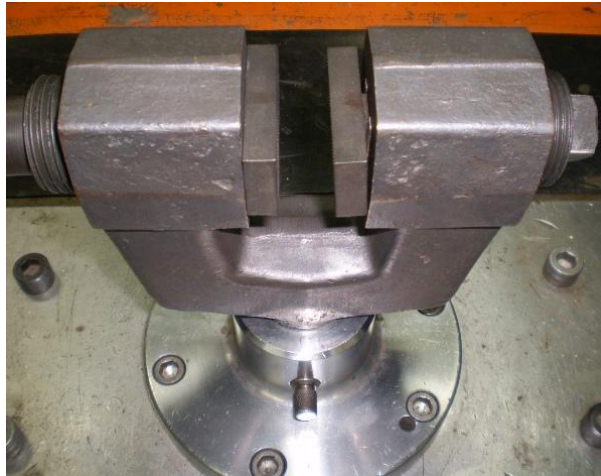
Figura 9 - Detalhe da garra utilizada no ensaio de tração do corpo de prova
