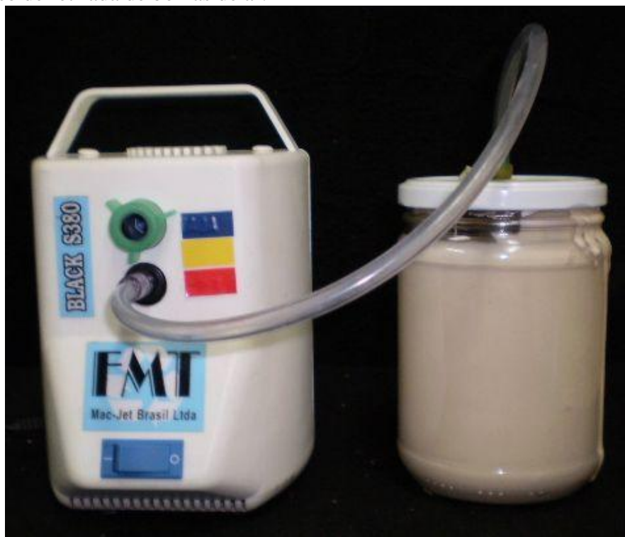
Figura 7 – Processo para retirada de bolhas da mistura
